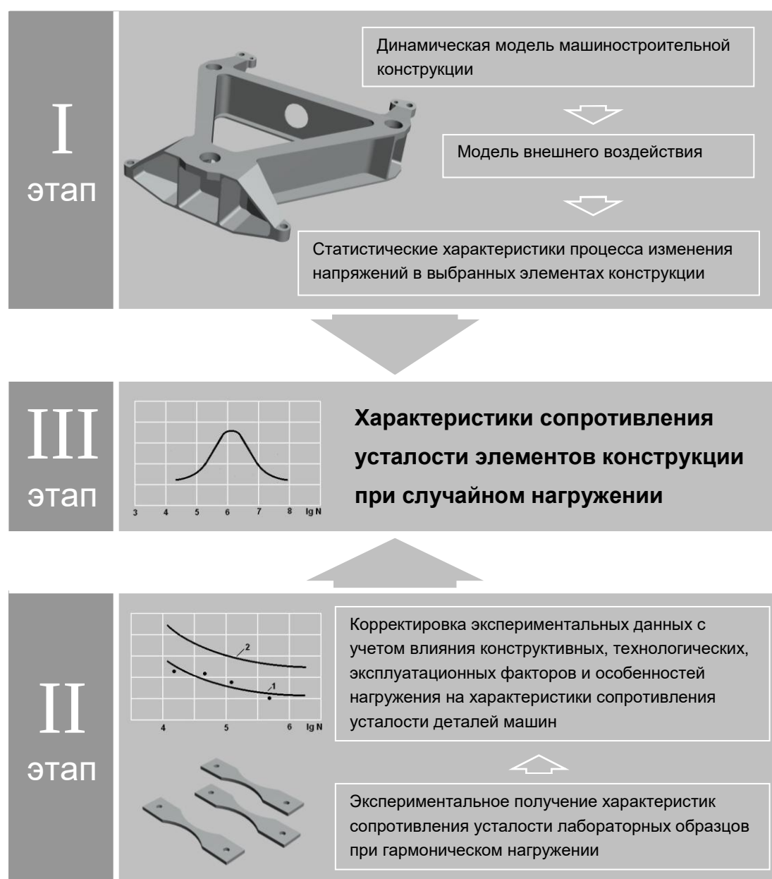
Рис.1. Структурная схема определения характеристик сопротивления усталости элементов конструкций при эксплуатационном воздействии
